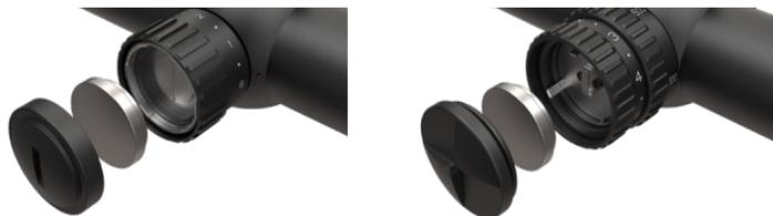
Při výměně baterie u puškohledu MeoStar R2 je nutné nastavit točítka osvětlovače na stupeň 8 (maximum). Jiný postup nezaručí správnou funkci osvětlovače! Odšroubujeme krytku, k tomuto je určena drážka pro minci, vložíme baterii se správně orientovanou polaritou, našroubujeme zpět krytku na doraz. Standardní typ baterie dodávaný s puškohledem je CR2354 3 V, součástí puškohledu je také kroužek pro použití menší verze baterie CR2032 3 V.
