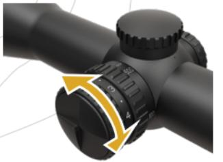
Après un tir d'essai correct avec la lunette à fusil montée sur le fusil, il est possible de régler la position du bouton à tourner comme nulle: Appuyer à l'aide de deux doigts le bouton à tourner en direction vers la lunette jusqu'à sentir la possibilité du mouvement libre du bouton sans enclenchements sur les deux côtés. Régler la flèche avec le repère sur le bouton à tourner contre le repère sur la tubulure et déverrouiller le bouton à tourner.
