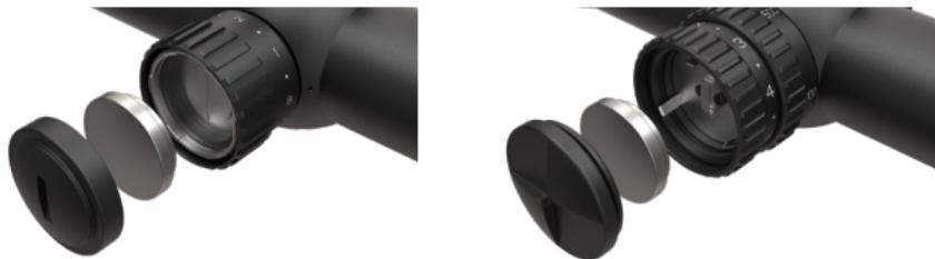
Při výměně baterie u puškohledu MeoStar R2 je nutné nastavit točítko osvětlovače na stupeň 8 (maximum). Jiný postup nezaručí správnou funkci osvětlovače! Odšroubujeme krytku, k tomuto je určena drážka pro minci, vložíme baterii se správně orientovanou polaritou, našroubujeme zpět krytku na doraz. Standardní typ baterie dodávaný s puškohledem je CR2354 3 V, součástí puškohledu je také kroužek pro použití menší verze baterie CR2032 3 V.
